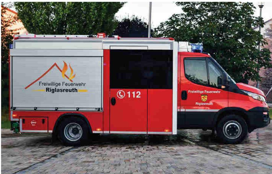
**Tragkraftspritzenfahrzeug Wasser (TSF-W) der Feuerwehr Riglasreuth**
