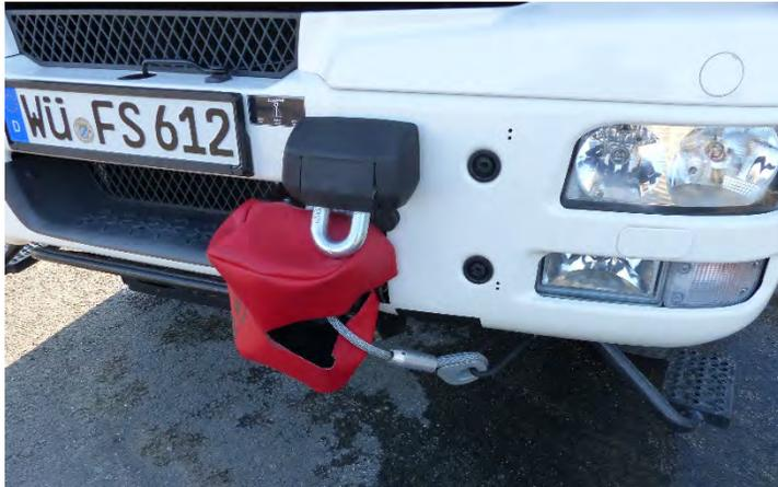
**Maschinelle Zugeinrichtung (Seilwinde)**
